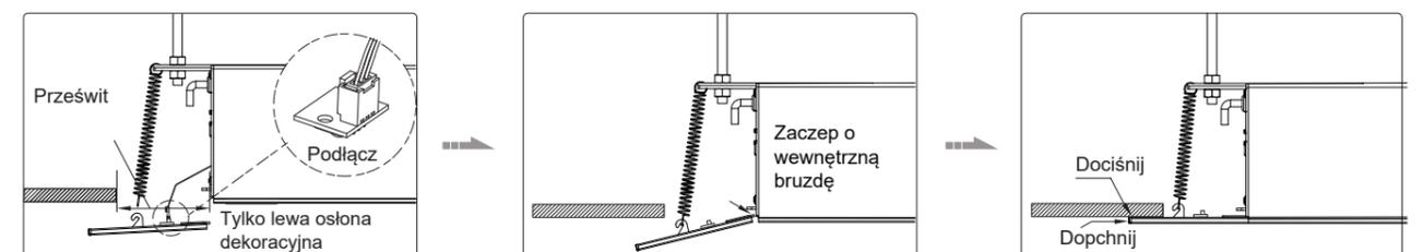
①. Przed rozpoczęciem instalacji upewnij się, że otwór instalacyjny ma wystarczający prześwit. Podłącz przewód podczerwieni, a następnie lekko rozciągnij sprężynę i przymocuj ją do haczyka na osłonie dekoracyjnej przez okrągły otwór na końcu sprężyny.
