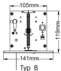
Wymiary otworu w suficie: Długość otworu  $L_t$  = całkowita długość ekranu  $L$  - 25mm, szerokość otworu 115mm, wysokość >120mm
